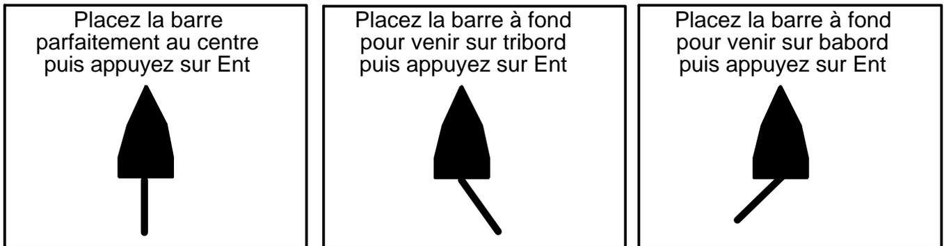
6) Dopo aver effettuato un auto test, che sposta la barra ad un bordo, il suo pilota è inizializzato,
